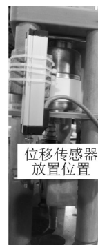
图10 位移传感器安装位置
